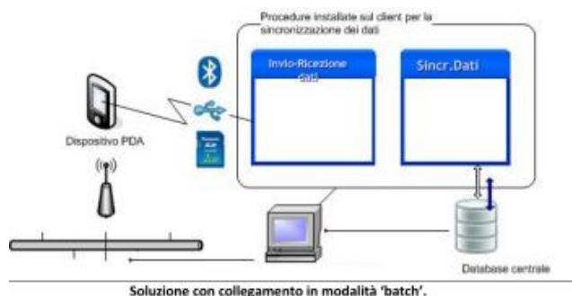
Soluzione con collegamento in modalità "batch".
